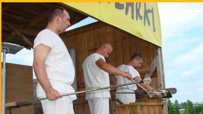
Pracownicy Hut Szkła Gospodarczego Tadeusza Wrześniaka demonstrowali tradycyjny sposób wytopu szkła.
