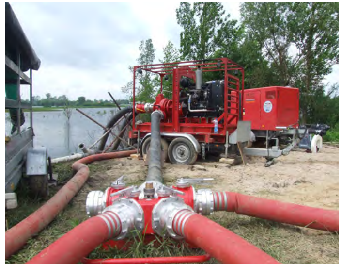
Jeden z rozdzielaczy do rozprowadzania wody, z lewej częściowo widoczna pompa „Andoria” z OSP Rybitwy.
